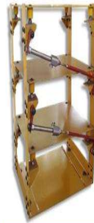
斜撐制震建築
